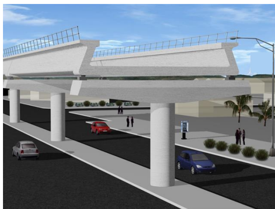
Schéma d'un viaduc à tablier profilé
