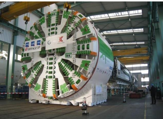
Photographie d'un tunnelier, source : Société du Grand Paris
