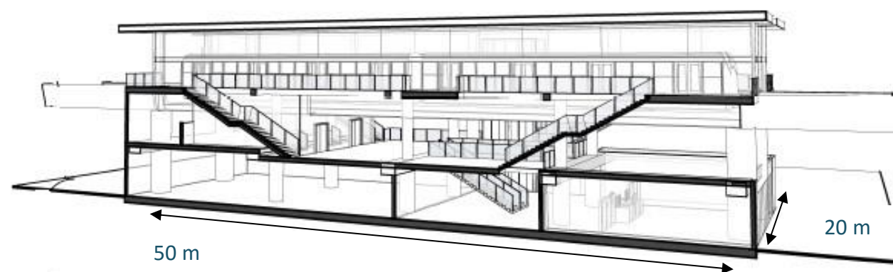
Schéma de principe des stations de type A1 en coupe 3D
