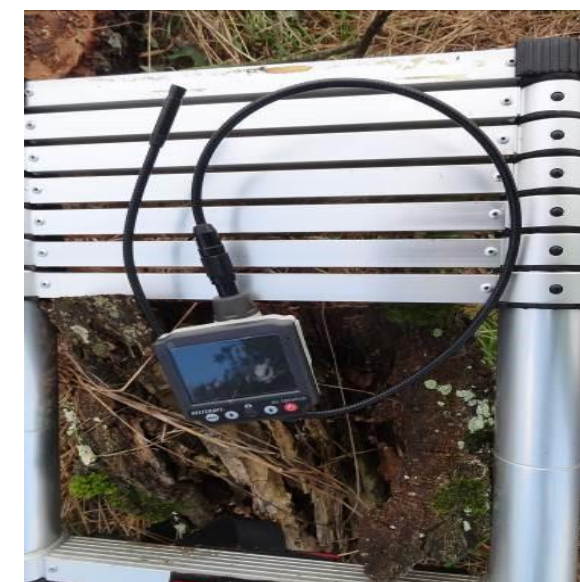
Inspection des cavités d'arbres favorables aux chiroptères, avec un endoscope
