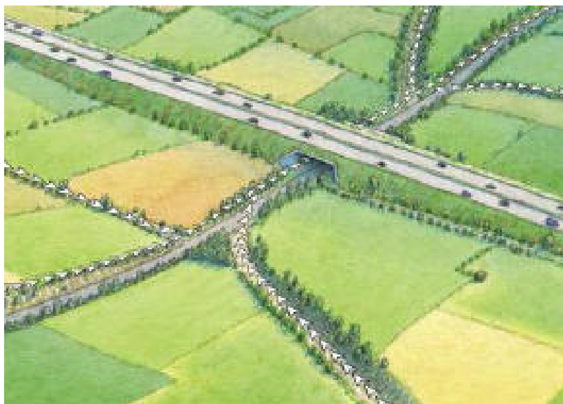
Ryc. 16. Przykład wykonania nasadzeń naprowadzających na przejazd pod drogą; źródło: Strategiczna ocena oddziaływania na środowisko dla Programu Budowy Dróg Krajowych na lata 2010 – 2015, Warszawa, lipiec 2010r.
