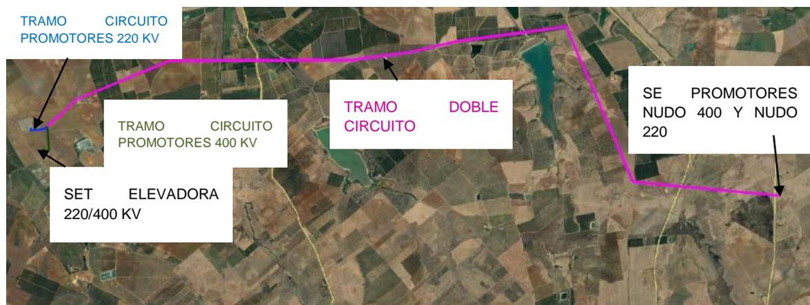
Ilustración 4 – Trazado de la línea de alta tensión
