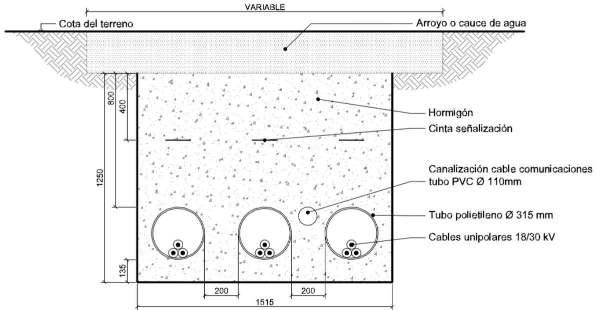
Ilustración 7 - Canalización Hormigonada Tres Conductores/Fase bajo Arroyo
