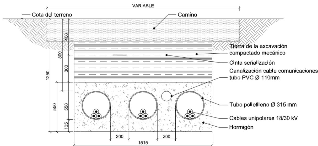
Ilustración 6 - Canalización Hormigonada Tres Conductores/Fase
