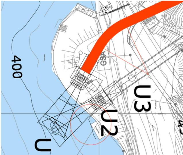
Abbildung 1: gedrehte Lage des Bauwerkes; rot neue Variante, rechts ursprünglicher Entwurf
