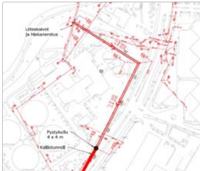
Kuva 8-11. Suunnitelma Viinikanlahden puhdistamon luona. Kuvassa esitetty kalliotunnelin alku ja pystykuilun sijainti. (Pää ja purkulinjoihin yleissuunnitelma 2011)
