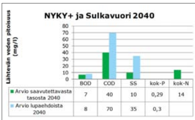
Kuva 7-1. Arvio NYKY+ ja Sulkavuorivaihtoehtojen jätevedenpuhdistamoilla saavutettavasta lähtevän jäteveden pitoisuudesta suhteessa arvioituihin lupaehtoihin vuonna 2040.
