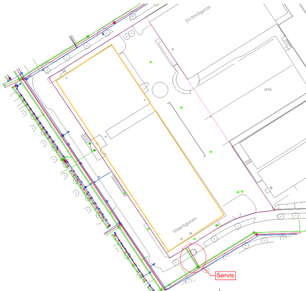
Figur 14. Befintliga VA-ledningar på allmän platsmark runt fastigheten Vitå 1. Lägen för brunnar (gröna punkter) på kvartersmark har ritats in i tolkat läge. Orange markering visar byggnaden där Exegers verksamhet planeras.
