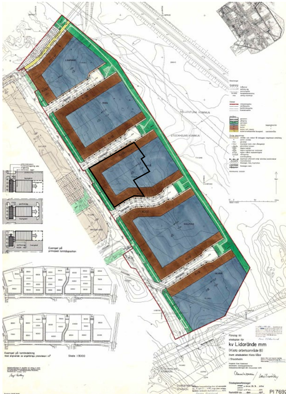
Figur 6. Detaljplanekarta för Stadsplan för kv Lidarände mm (Kista arbetsområde B). Svart markering visar ungefärlig gräns för aktuell fastighet Vitå 1. De blå markeringarna (planbeteckning J) betyder yta avsedd för industri- och lagerändamål, de bruna markeringarna (planbeteckning RJ) får användas till kontors- lager- och industriändamål. Gröna ytor är markerade "parkmark".
