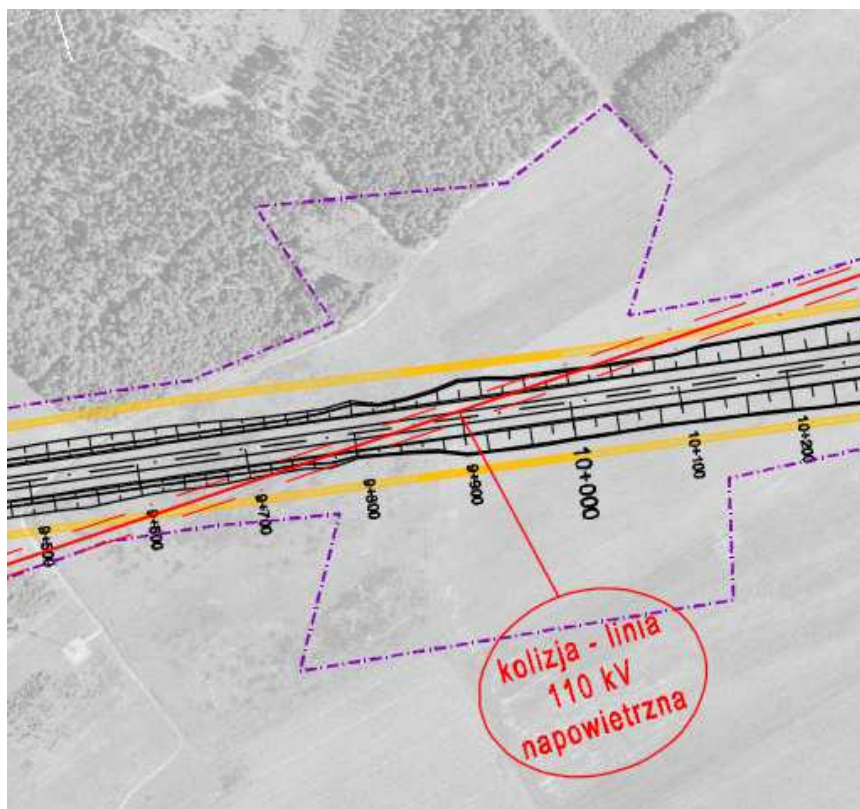
Rysunek 15-3 Kolizja wariantu (III) zielonego z linią 110 kV (napowietrzną) w km 9+900
