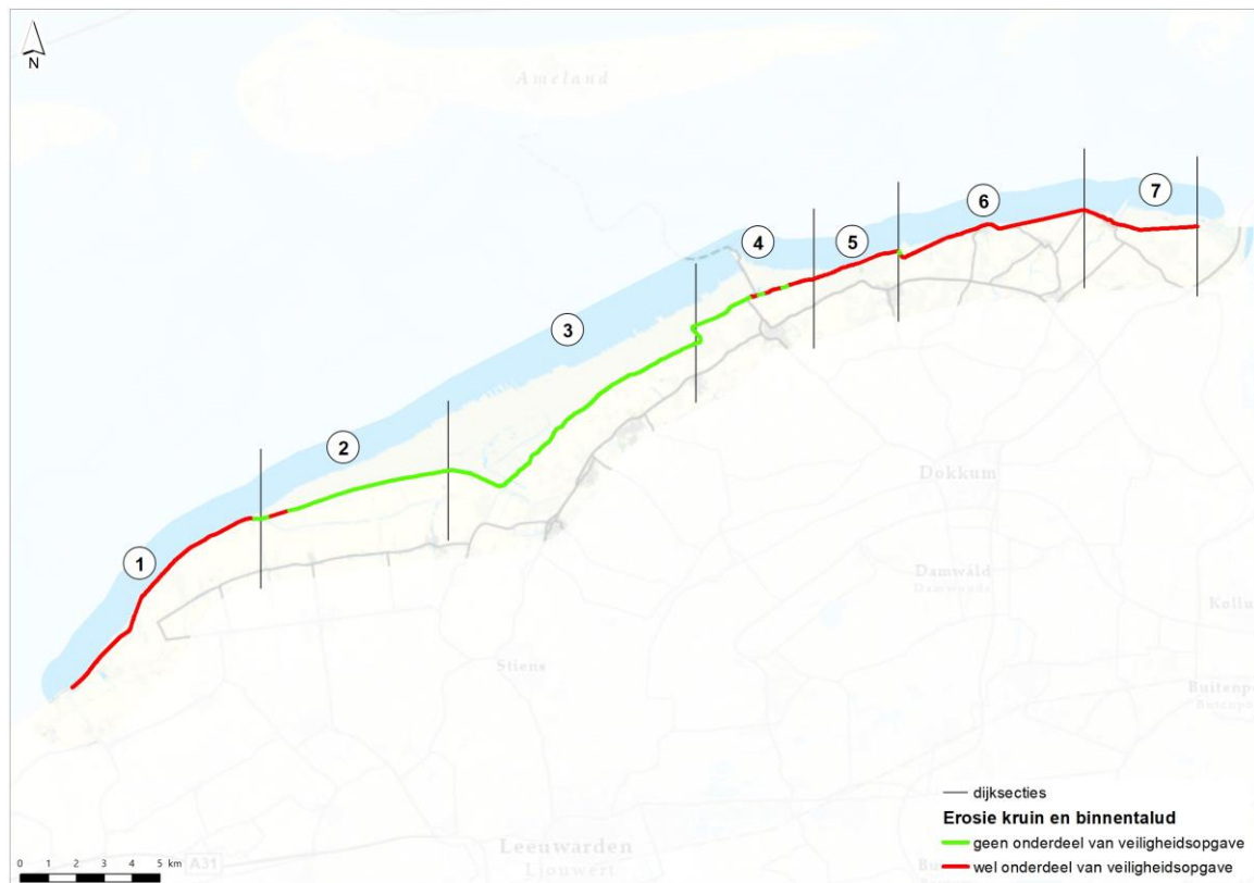
Afbeelding 2.7 Erosie kruin en binnentalud
