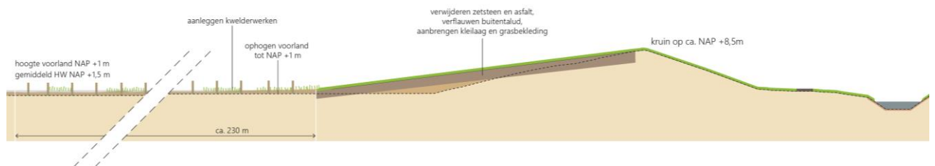
Afbeelding 3.6 Voorbeeld variante 3: zachte bekleding en voorland
