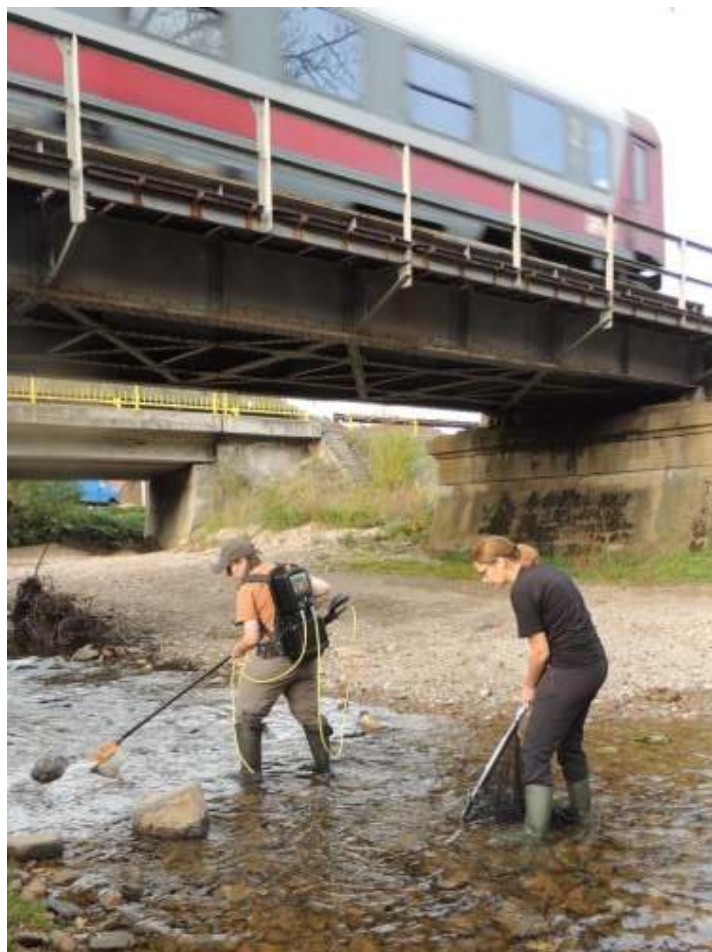
Figura nr. 5-69 Realizarea investigațiilor cu ajutorul aparatului de electronarcoză
