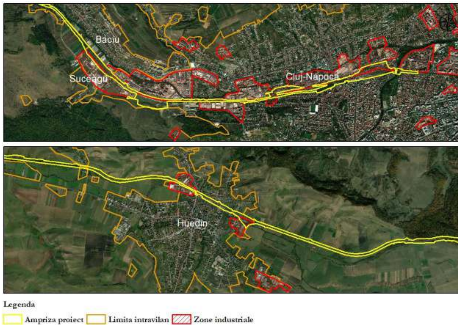
Figura nr. 5-27 Zonele industriale potențial contaminate din zona de implementare a proiectului din județul Cluj
