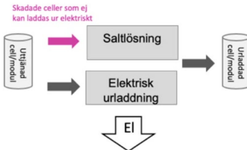
Figur 5-6 Schematisk illustration över urladdningen.
