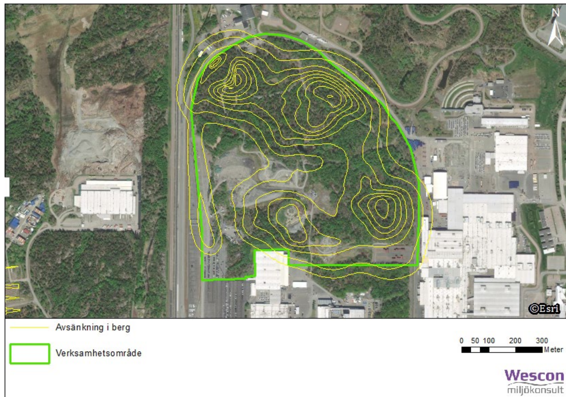
Figur 7-10. Påverkansområde för avsänkning av grundvatten i berg.
