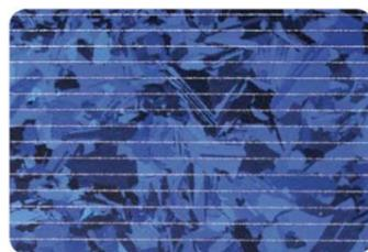
Figure 7 :Cellule de type poly-cristallin
