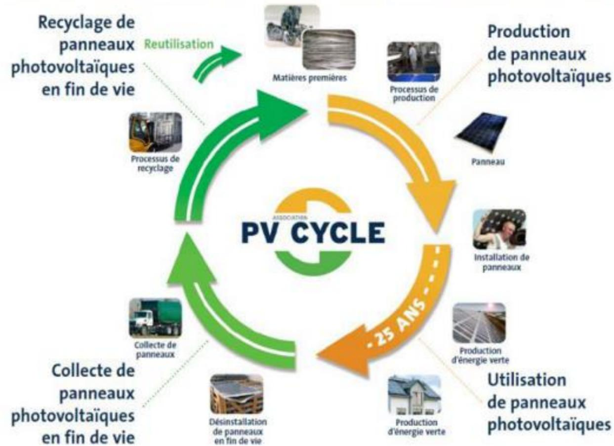
Figure 29 : Cycle de vie des panneaux photovoltaïques en silicium cristallin
