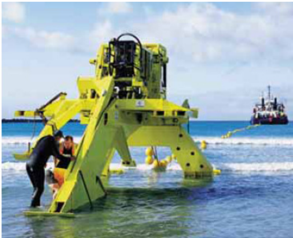
Joonis 51. Illustreeriv foto adrast, mida on võimalik kasutada kaabli süvistamiseks merepõhja (Berr 2008).
