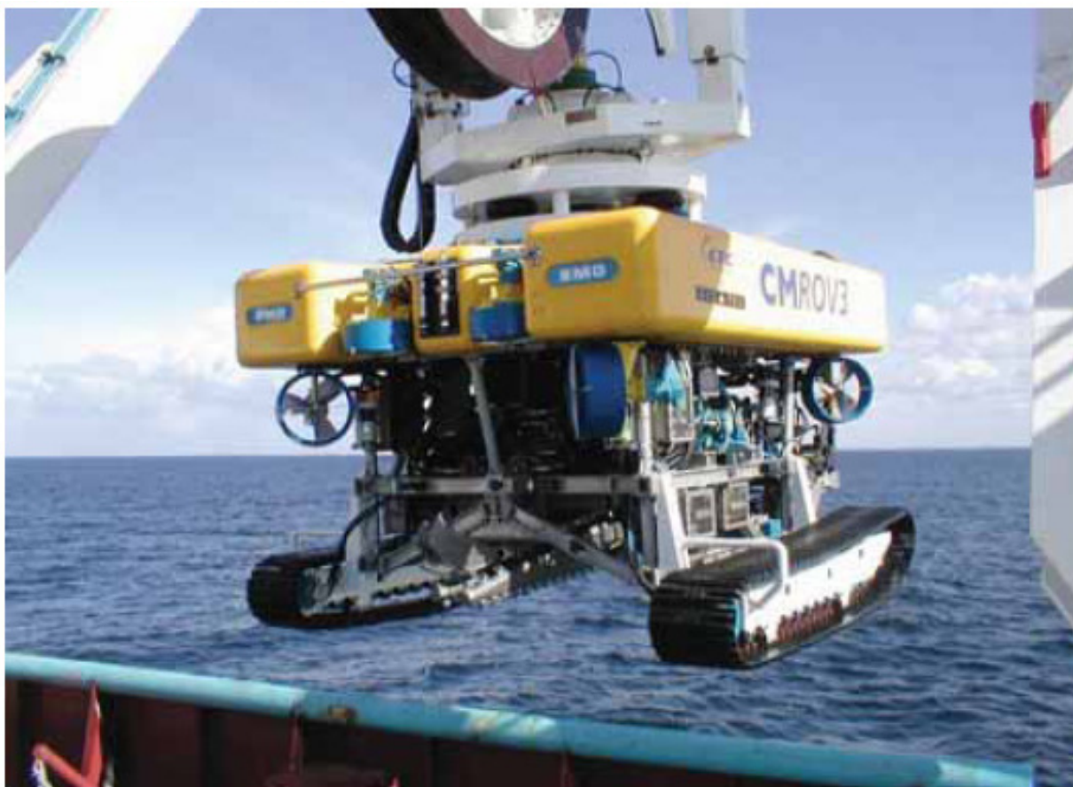
Joonis 53. Illustreeriv foto Water jet 'ist mida on võimalik kasutada kaabli süvistamiseks merepõhja (Berr 2008).
