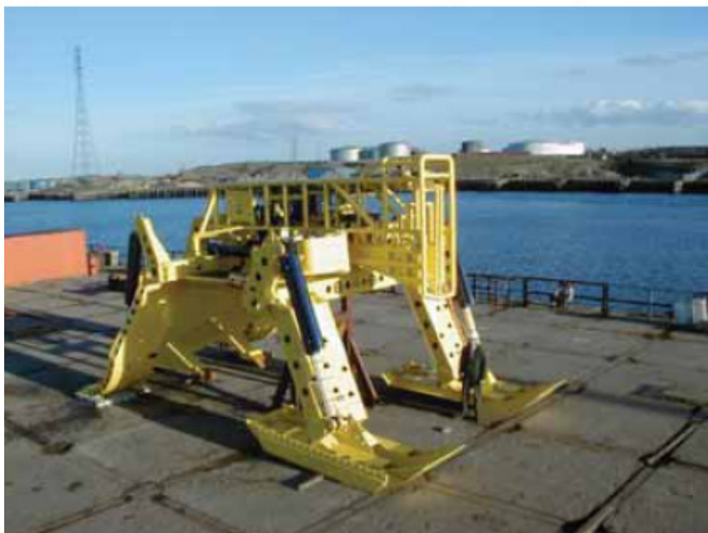
Joonis 52. Illustreeriv foto adrast, mida on võimalik kasutada kaabli süvistamiseks merepõhja (Berr 2008).
