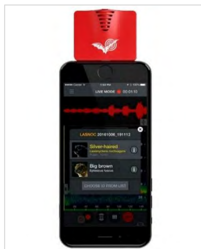
Fotografía 3. Detector de ultrasonidos acoplado al smartphone
