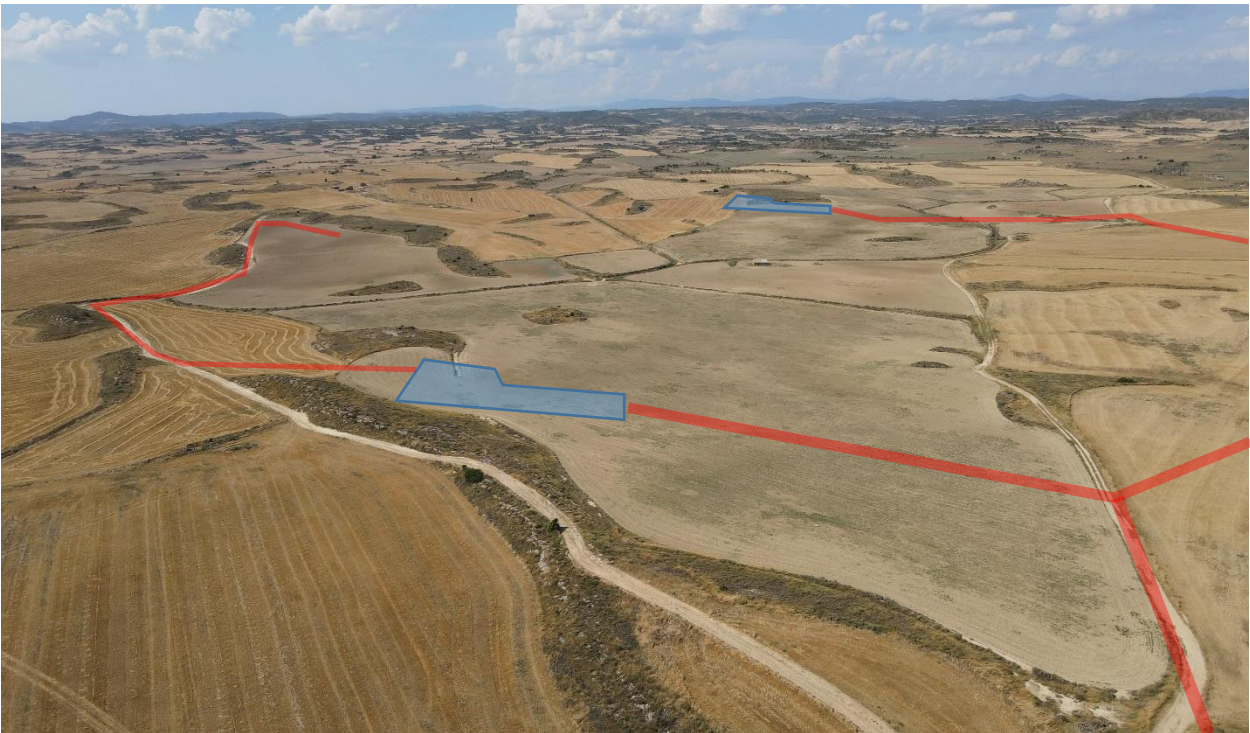
Fotografía 5: Vista de la zona de la zona de ubicación del aerogenerador SR-02 en zonas de cultivo (al fondo SR-01). Se marca en azul la zona de ocupación de la plataforma y en rojo los viales del parque eólico. El camino que sale de SR-02 hacia la derecha da acceso hasta la torre de medición, también situada en campos de cultivo.
