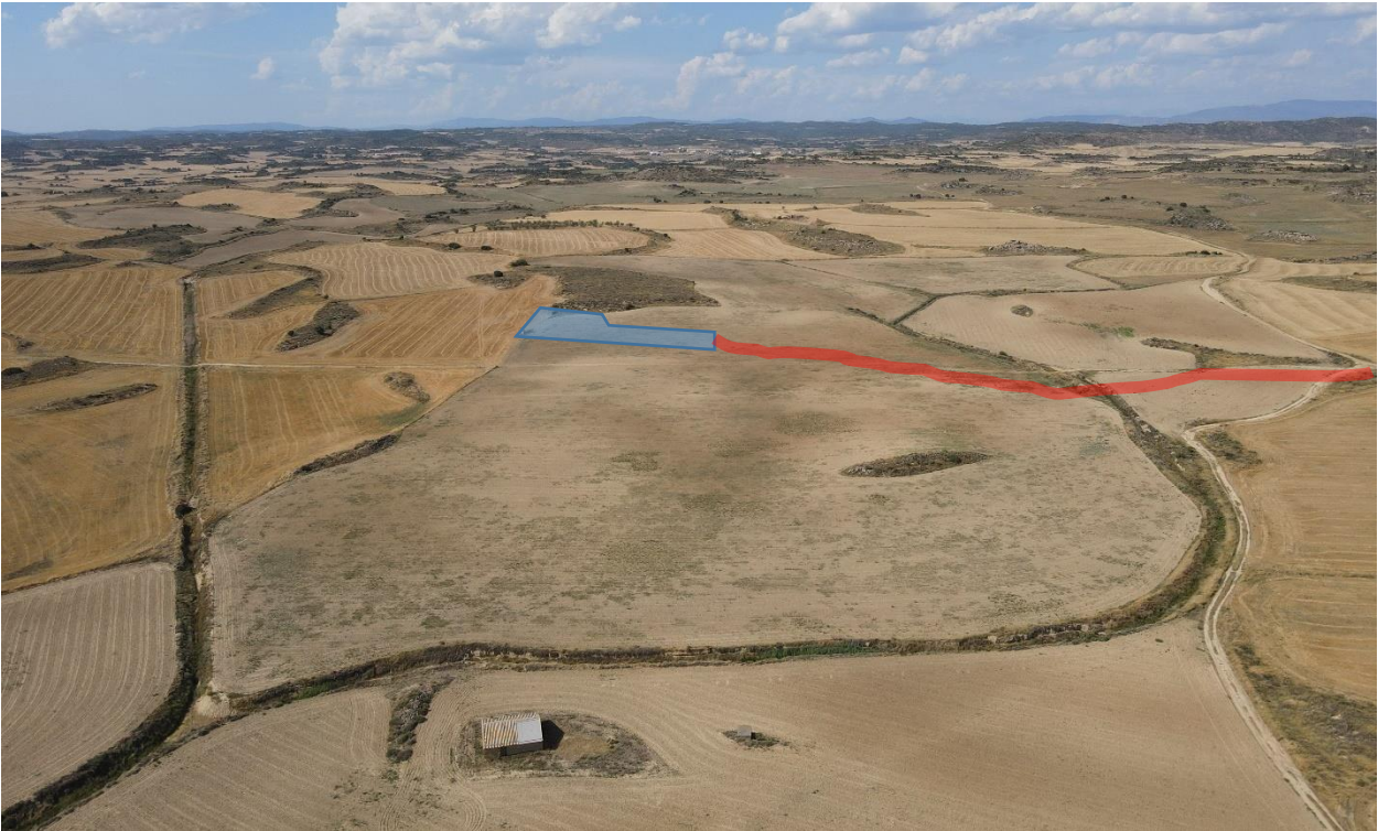
Fotografía 4: Vista de la zona de la zona de ubicación del aerogenerador SR-01 en zonas de cultivo. Se marca en azul la zona de ocupación de la plataforma y en rojo el acceso hasta la misma.
