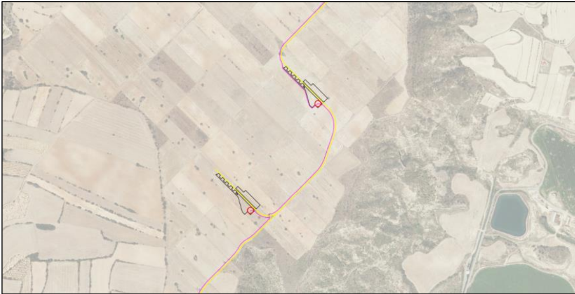
Imagen de los aerogeneradores 3 y 4, plataformas y sus accesos sobre ortofoto. Fuente: propia.
