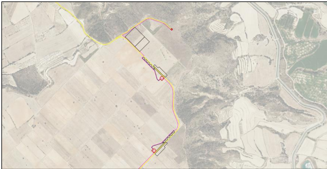
Imagen del site camp, torre de medición, aerogeneradores 1 y 2, plataformas y sus accesos sobre ortofoto. Fuente: propia.
