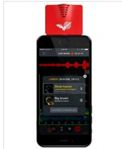
Fotografía 3: Detector de ultrasonidos acoplado al smartphone
