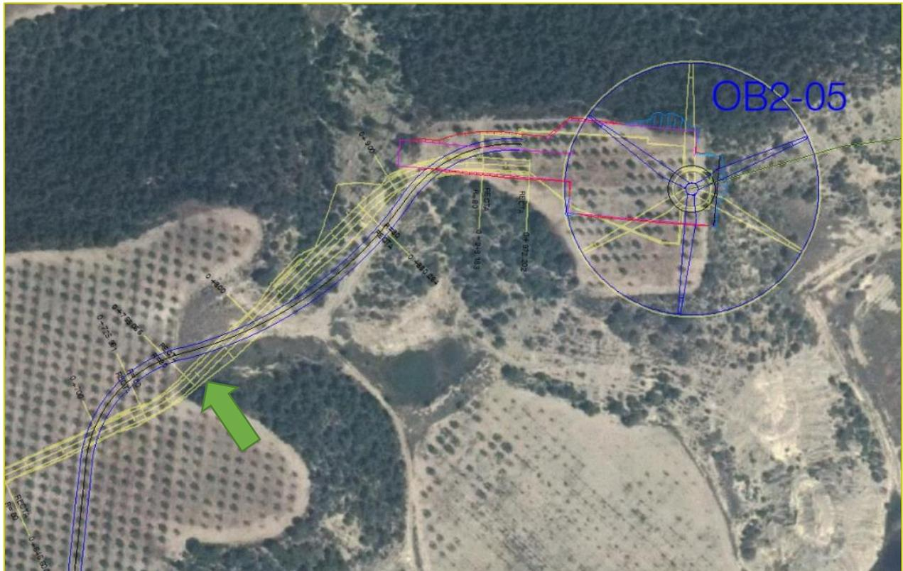
**Figura 4.** *Modificación del vial de acceso al aerogenerador OB2-05. DETALLE.*
