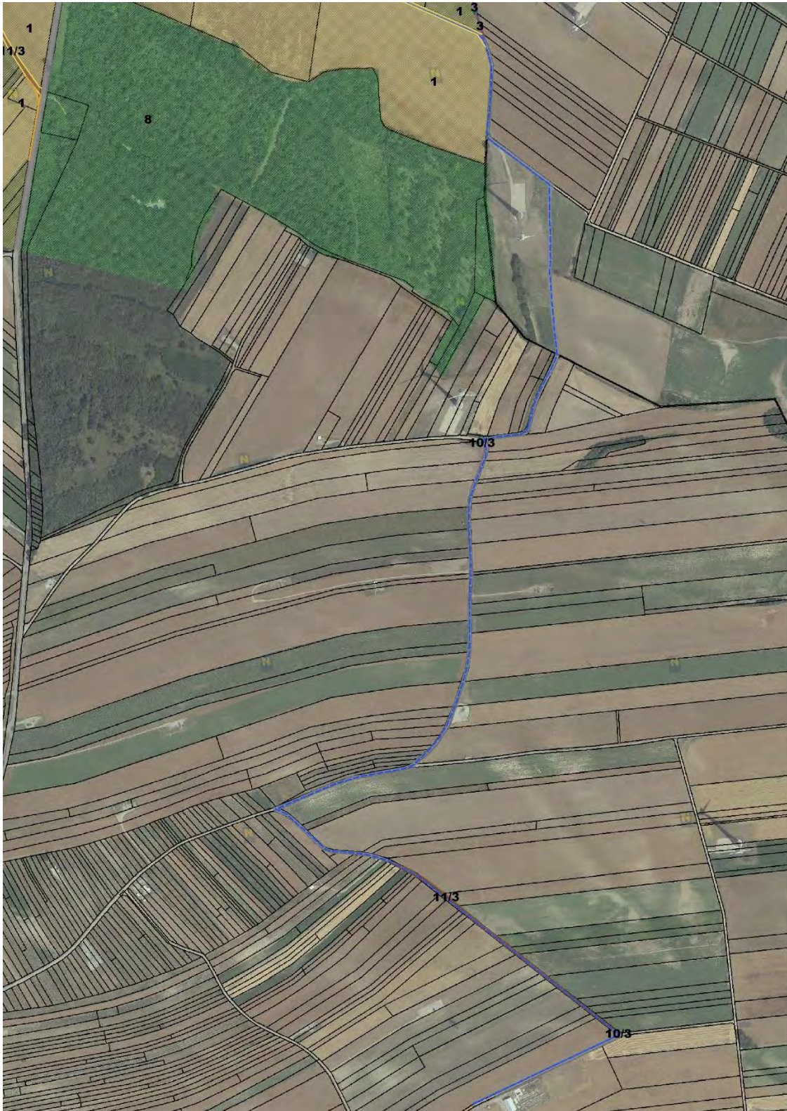
Abb. VE 5: Externe Kabeltrasse des WP Prottes II
