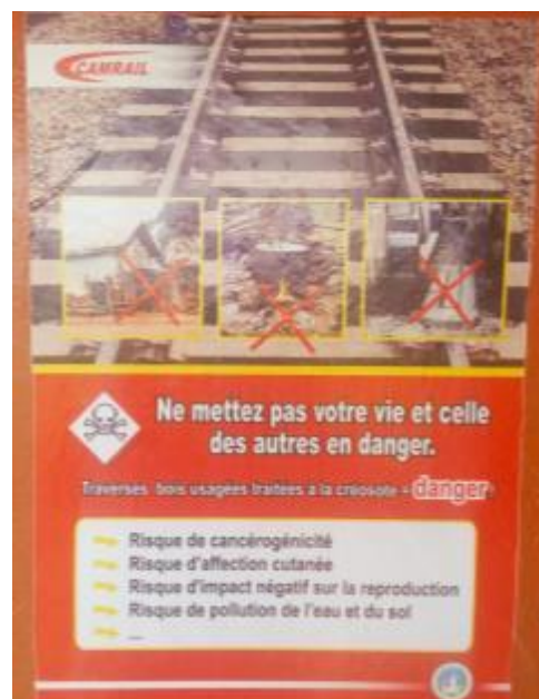
Photo 72. Affichage de sensibilisation contre l'utilisation des traverses de bois de la voie ferroviaire pour les feux de bois Source groupement YUKSEL PROJE/INTEGC /TEC-CUATRO
