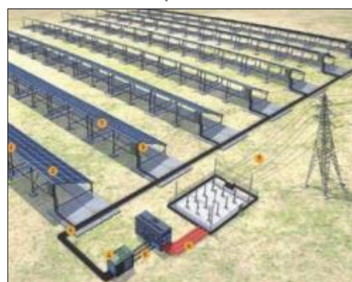
Illustration 76 : Composants de l'installation
