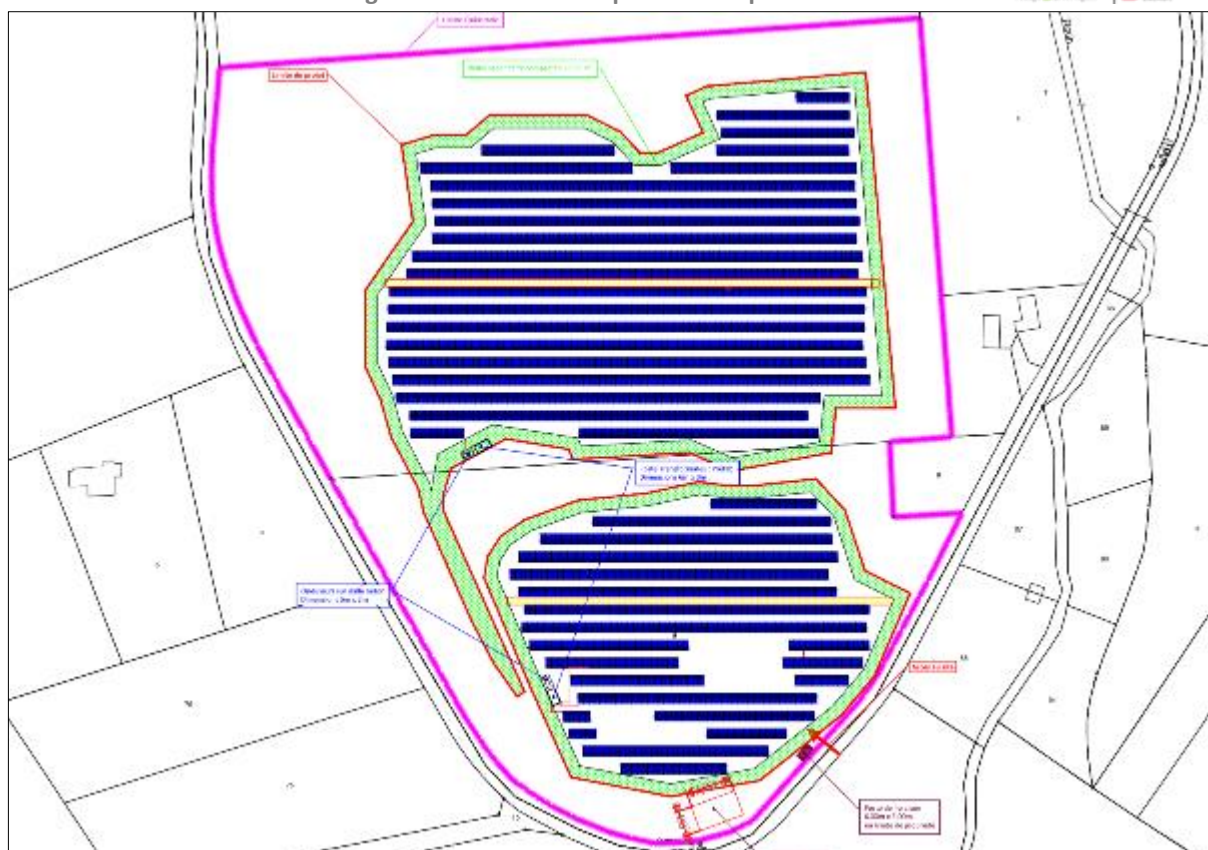
Illustration 10 : Schéma d'aménagement de la centrale photovoltaïque
