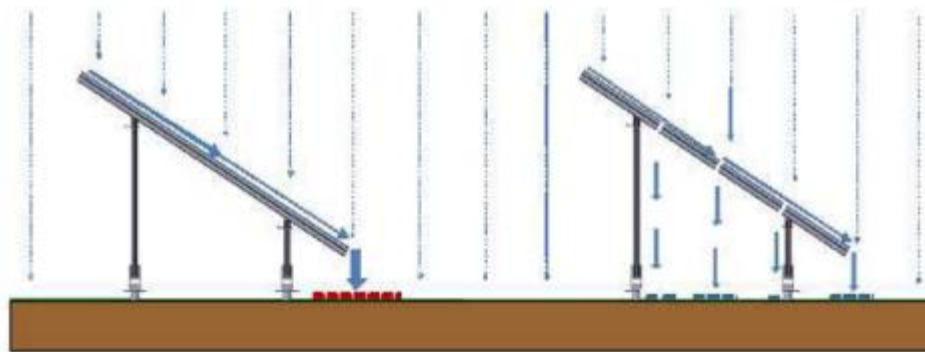
Illustration 15 : Effet de la jointure des panneaux sur le risque d'érosion
