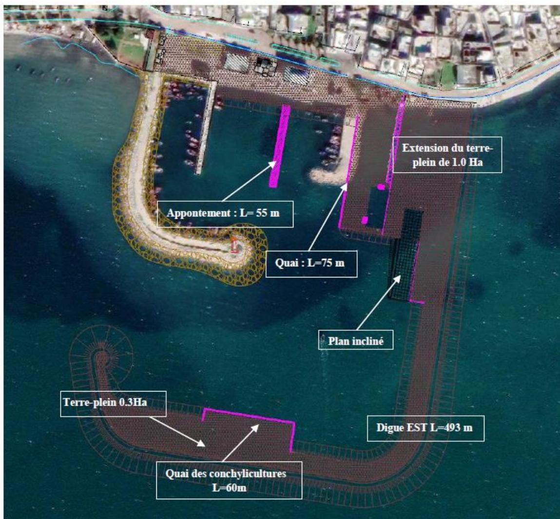
Figure 2 : Plan masse de l'extension et l'aménagement du port de Menzel Abderrahmane
