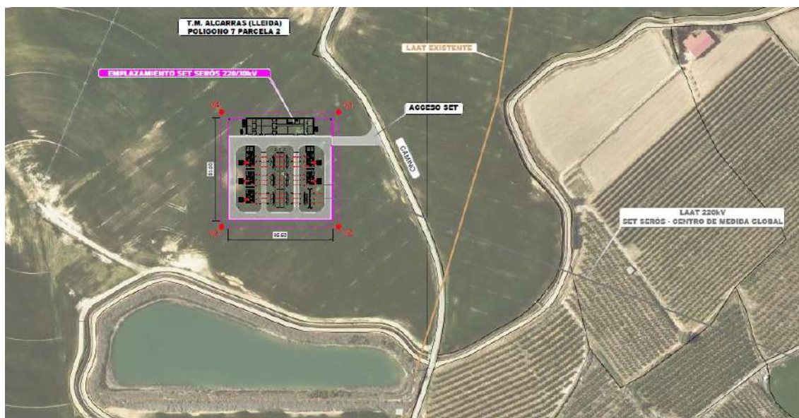
Figura núm. 4. Implantació de la nova SET Seròs sobre ortofotomapa. Font: Proyecto de la SET Seròs 30/220 kV (Inproin)
