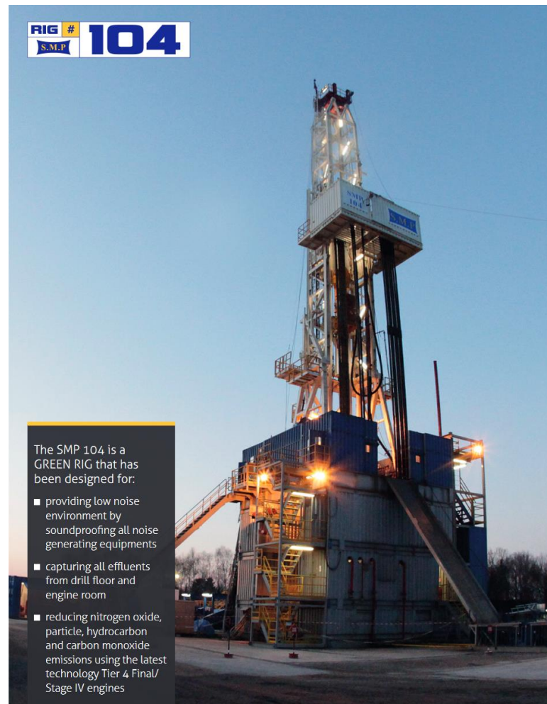
Figure 159 : Illustration de l'appareil de forage SMP104 qui pourra être utilisé pour la réalisation du doublet géothermique.
