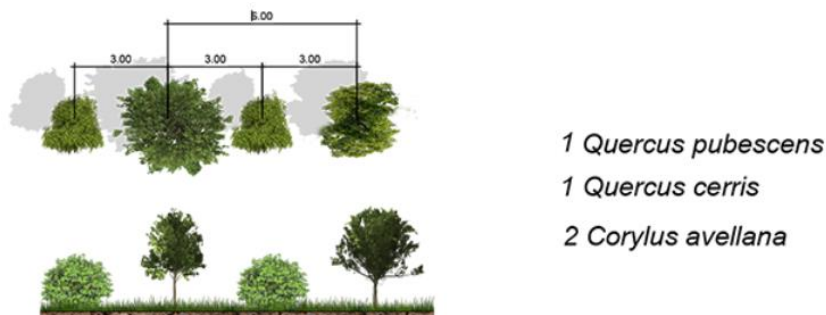
Figura 39 – Ripristino lato Ovest: modulo arboreo arbustivo ad Ovest
