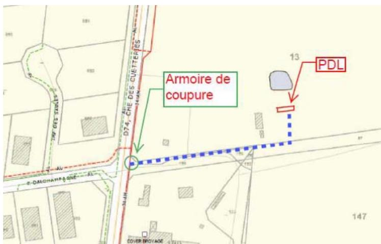
Figure 11 : solution technique de raccordement envisagée
