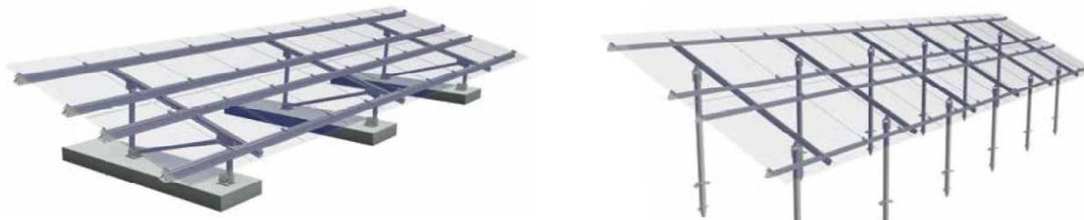
Figure 9 : Illustration de tables sur longrines (à gauche) et sur vis d'ancrage (à droite)
