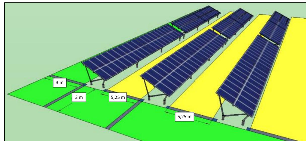
Figure 26 : Illustration des distances entre les structures et le chemin périphérique
