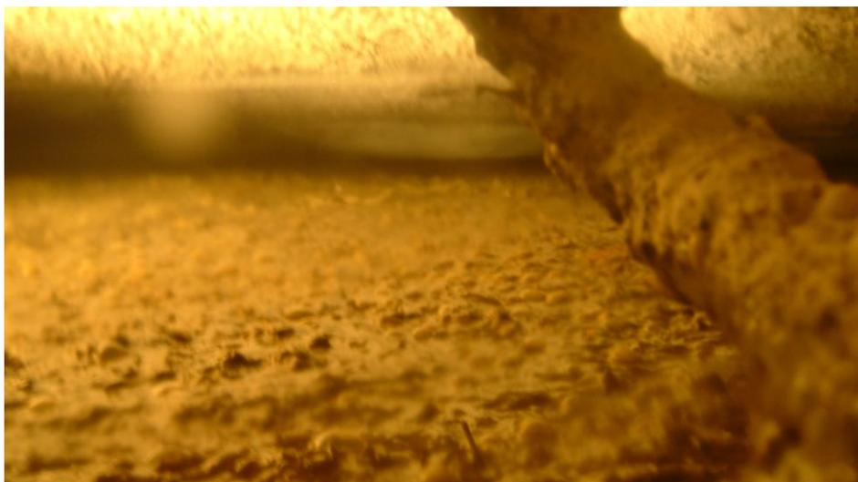
Figure 19 : Dépôt de soufre dans double membrane
