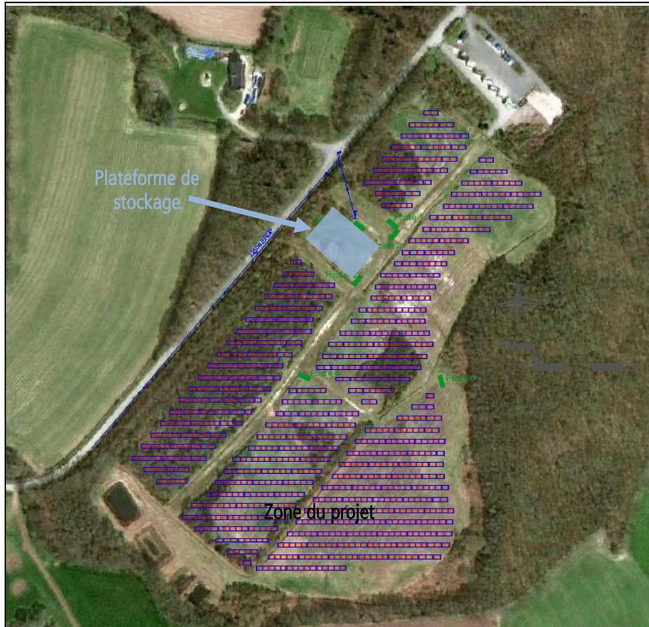
Figure 4 : Emplacement de la plateforme de stockage des éléments
