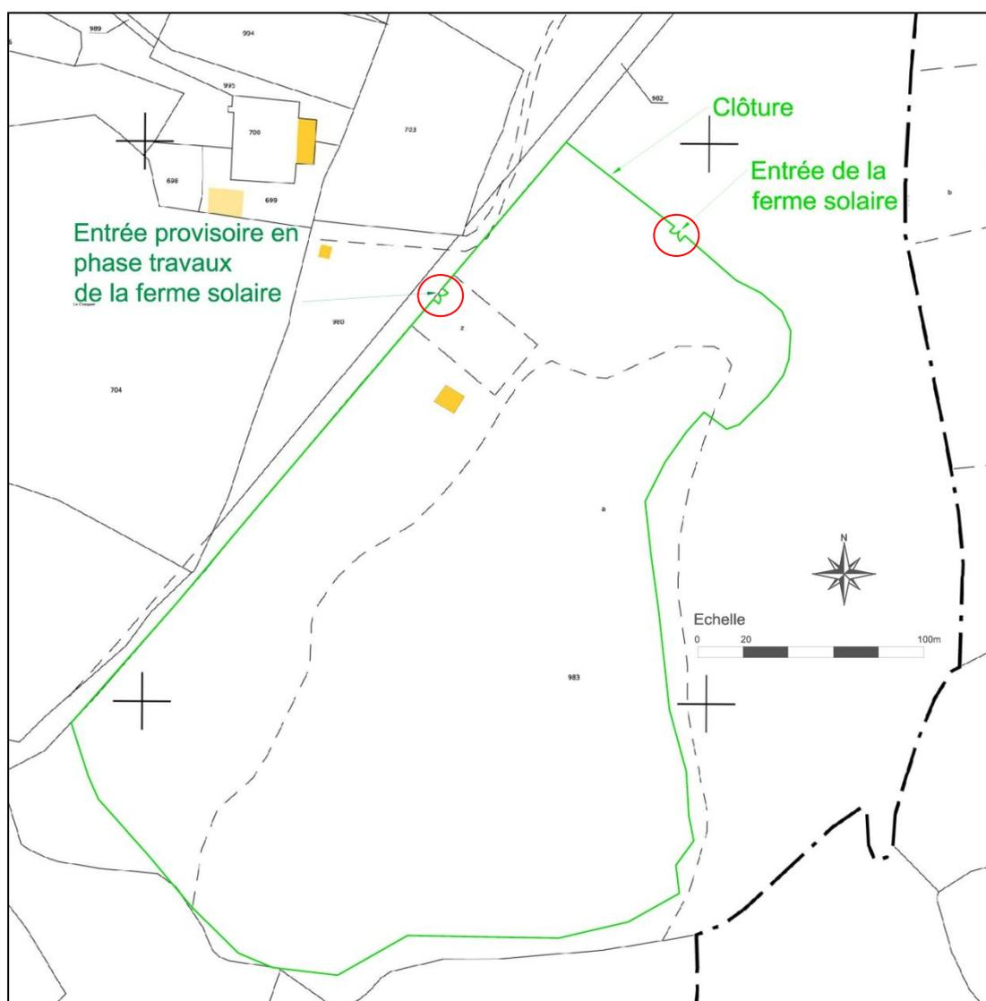
Figure 33 : Position de la clôture et des portails d'accès existant et futur
