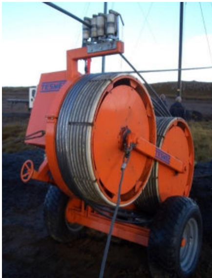
Mynd 3.10. Leiðari þræddur í gegnum strengingarvél (bremsa).
