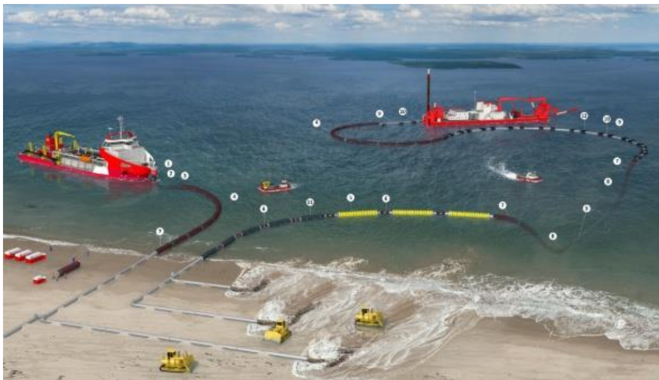
Figura 51 - Operazioni di refluito idraulico (Royal IHC, 2018)
