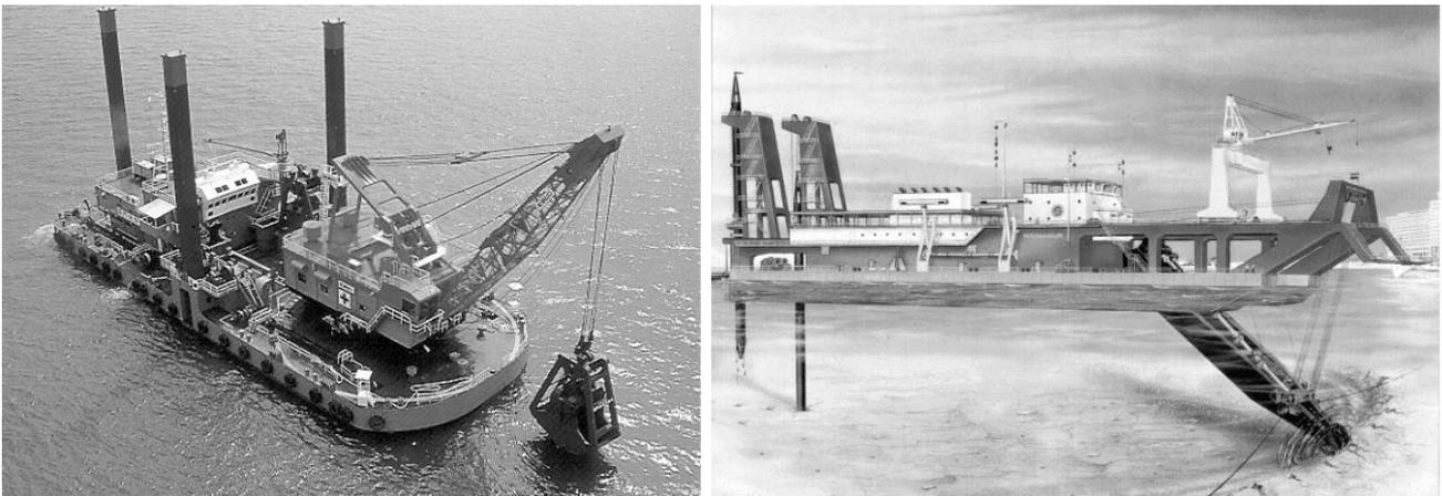
Figura 4.34 - Draghe a benna del tipo a fune (a sinistra) e aspirante refluite stazionaria (CSD, a destra)
