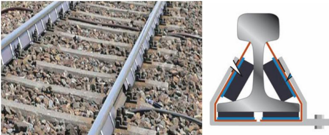
Rys. 8.12 Przykład rozwiązanie i przekroju „tłumika ekranującego” – obudowy, typu SSA (źródło: DB Netz AG, LeDosquet)
