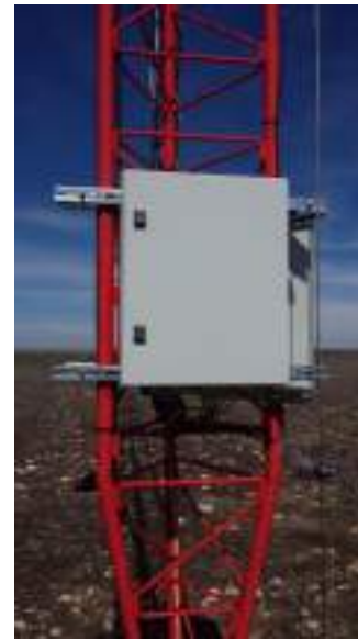
Fotos 67 y 68: Detector quirópteros instalado en torre de medición del PE Valdemoro.
