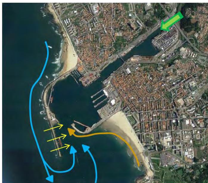
Figura 78 – Modelo concetual da dinâmica sedimentar na área do porto de Leixões: trânsito litoral (a azul), dinâmica na Praia de Matosinhos / Internacional (a laranja), fonte sedimentar proporcionada pelo rio Leça (a verde), atravessamento do quebra-mar exterior (norte) do porto (a amarelo)
