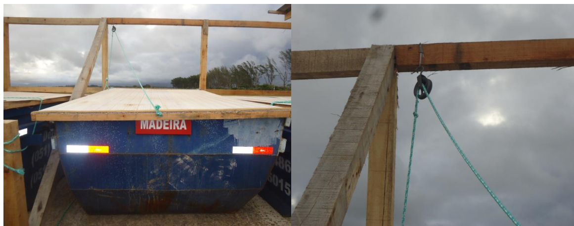
Figura 6. Exemplo de cobertura de PVC e madeira ligada a uma roldana para abertura manual (esquerda), detalhe da roldana presa em uma estrutura de madeira (direita). Imagem meramente ilustrativa.
