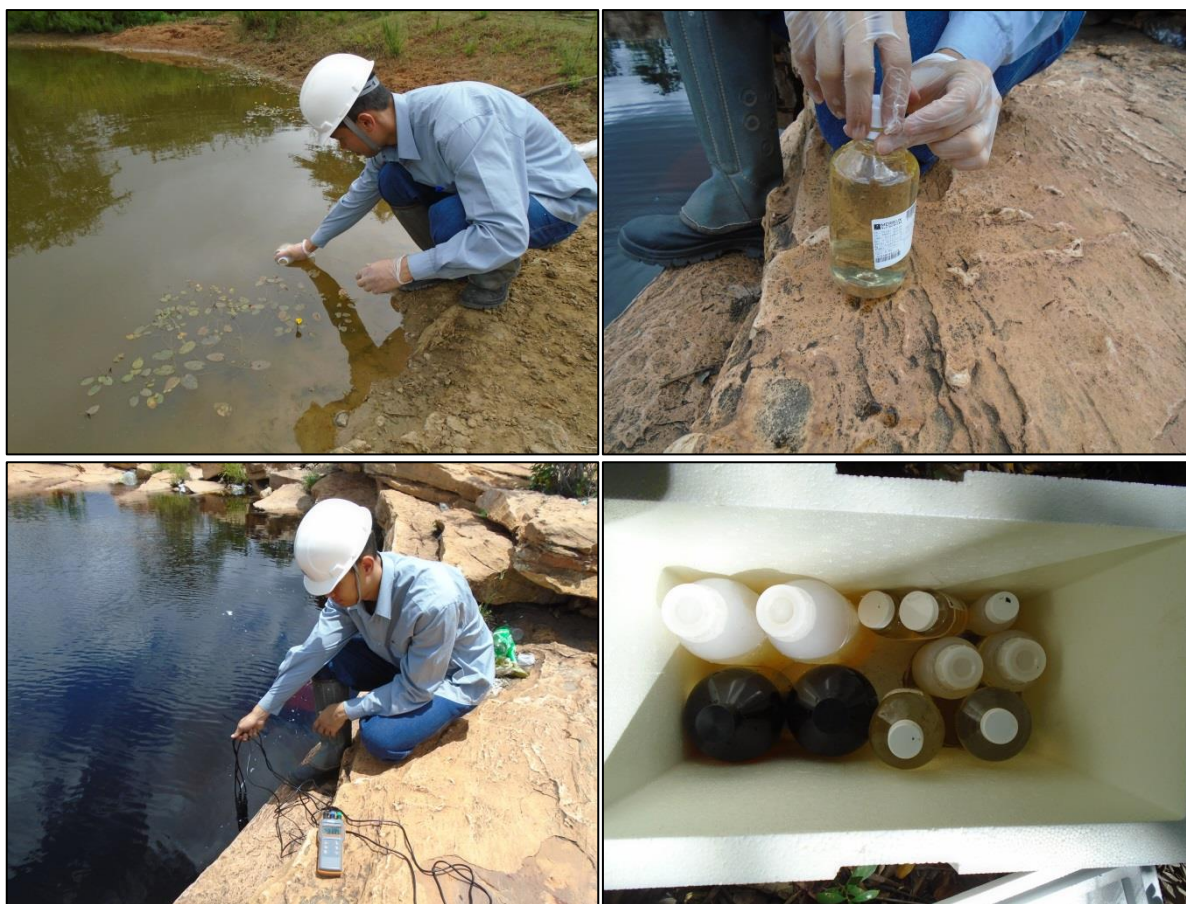
Foto 9.01 - Exemplo de Coleta, Medição em Campo e Acondicionamento de Amostras de Água
