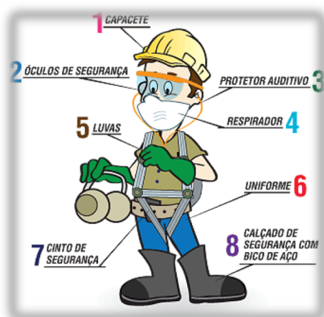
Figura 2.6.6.1.2_a: Exemplos de alguns dos EPI's destinados aos trabalhadores envolvidos com as atividades de corte madeireiro.
