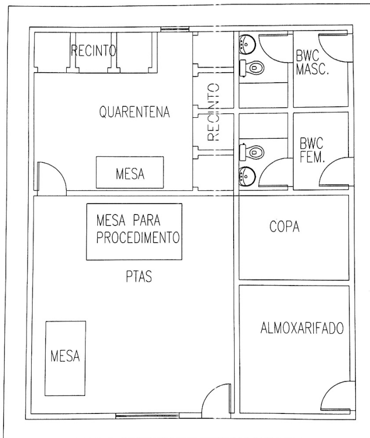
Figura 2.8.6.8_a: Sugestão de planta baixa do Posto de Triagem de Animais Silvestres (PTAS).
