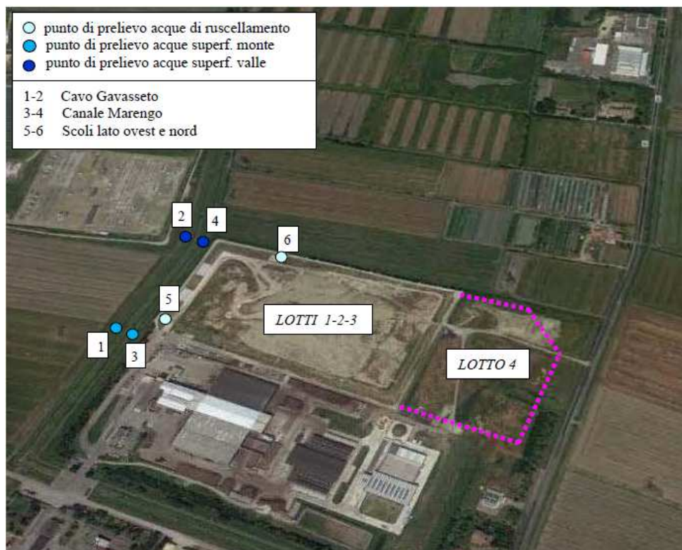
Figura 2 - Planimetria Discarica di Aimag di Fossoli di Carpi con rete di monitoraggio delle acque superficiali e meteoriche di ruscellamento.
