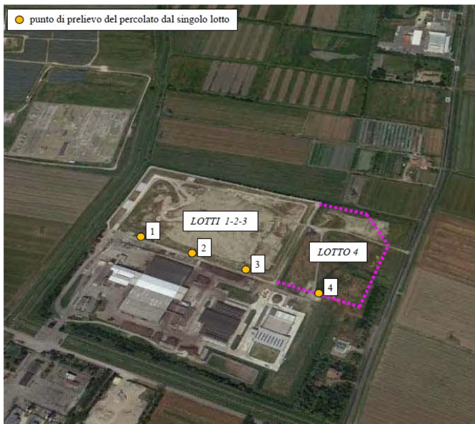
Figura 3 - Planimetria Discarica di Aimag di Fossoli di Carpi con rete di monitoraggio delle acque di percolazione.
