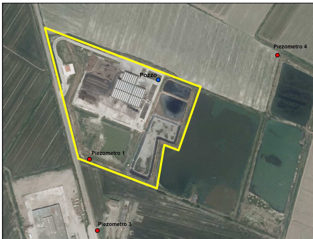
Figura 1 - Planimetria Impianto di compostaggio AIMAG di Finale Emilia con la rete di monitoraggio dei piezometri esistenti.
