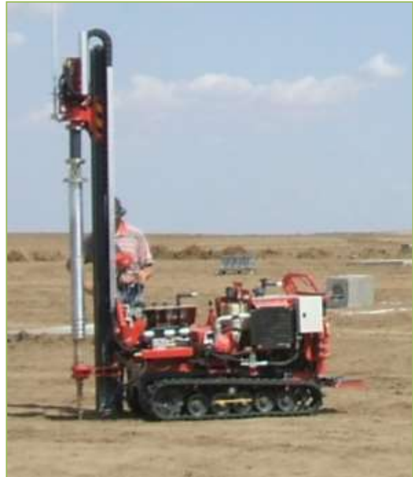
Figure 43 : Engin utilisé pour l'ancrage des panneaux solaires photovoltaïques
