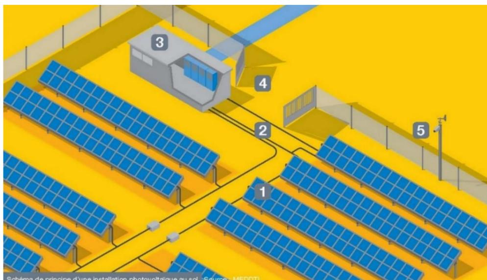
**Figure 5 : Principe d'une installation photovoltaïque au sol**
