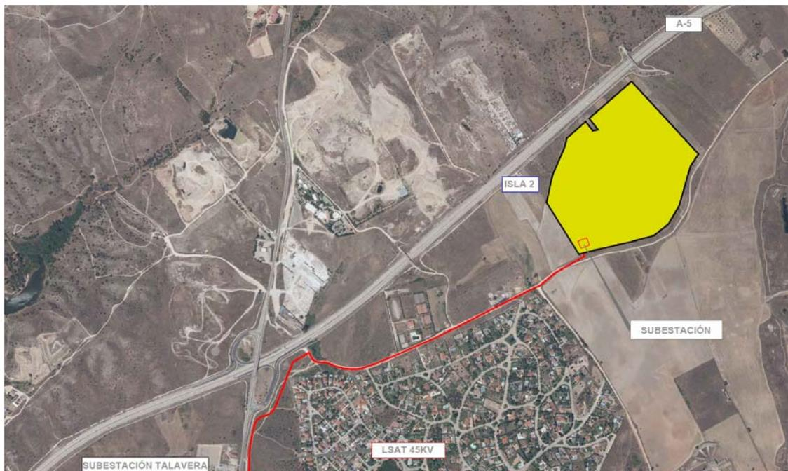
Figura 1.6.4.2.1 - Trazado LAAT
