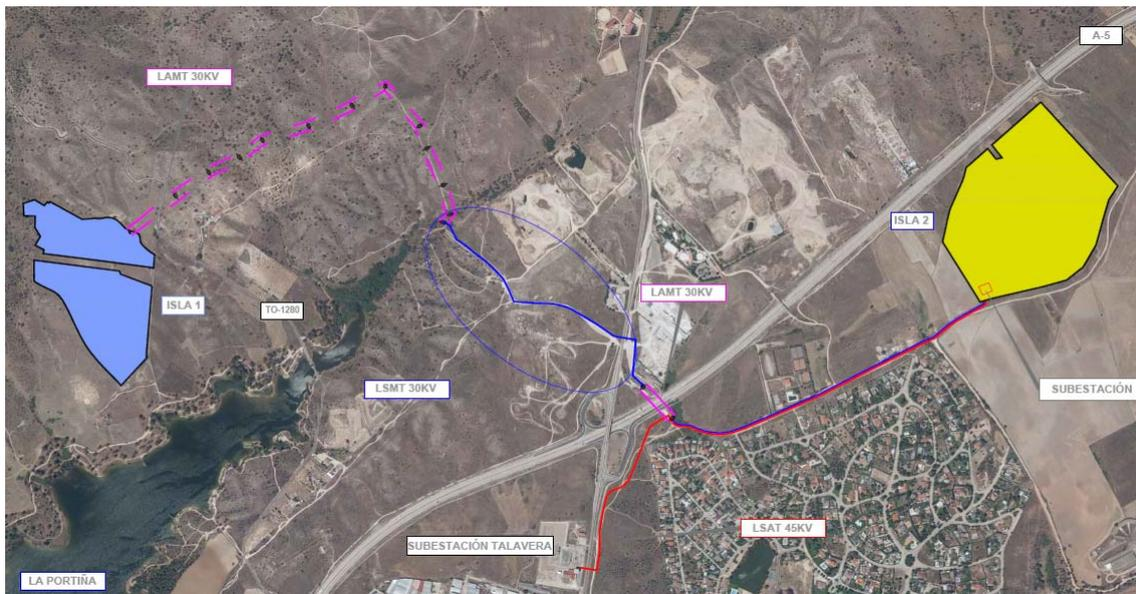
Figura.1.6.4.2.4- Tramo soterrado de la línea de MT. (A parte del común MT-AT)
