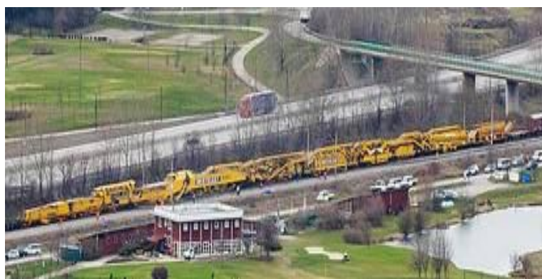
Foto 2.1. – Tehnologie mecanizată de reabilitare a infrastructurii CF
