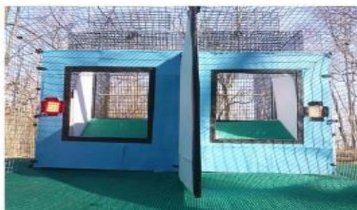
Figura 1.6.5.7.3. Corredores de vuelo iluminados con diferentes tipos de luces para comprobar el comportamiento de las aves
