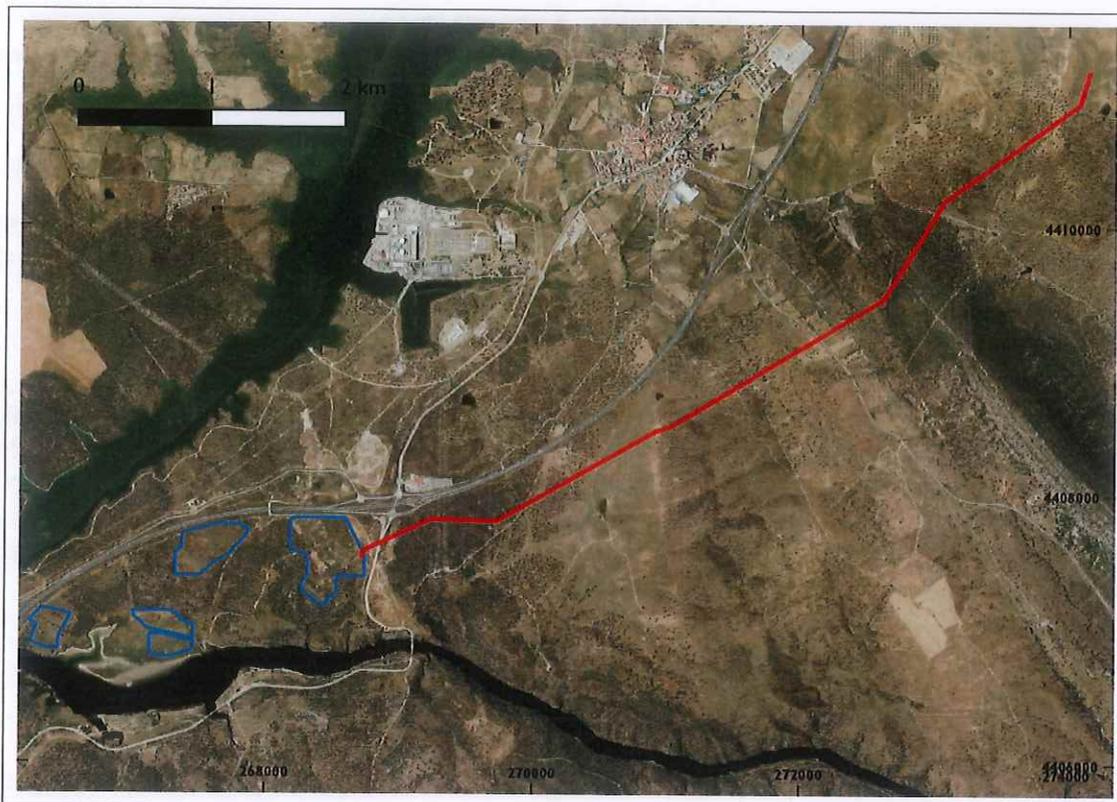
Mapa 2. Planta de producción de energía eléctrica fotovoltaica denominada "Arañuelo III" (azul) y línea eléctrica aérea de evacuación (rojo). Escala 1:40.000.
