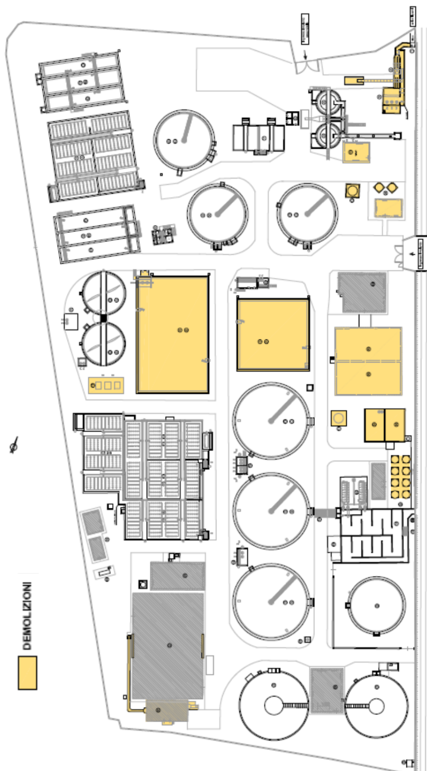
FIG. 4.5 PLANIMETRIA DELLE DEMOLIZIONI
