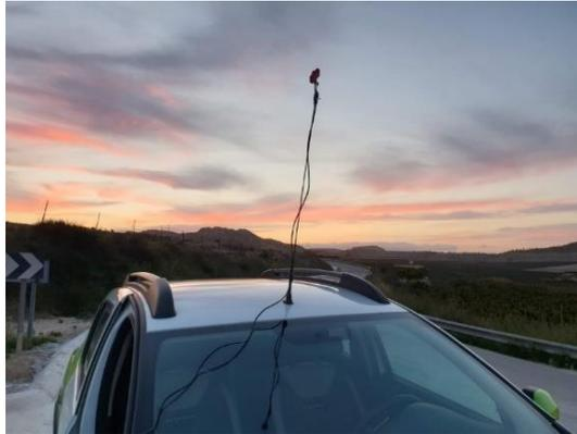
**Fotografía 2.6.3.6.a.** Acople del detector de ultrasonidos a antena para transectos en vehículo. Fuente: Ideas Medioambientales, S.L.
