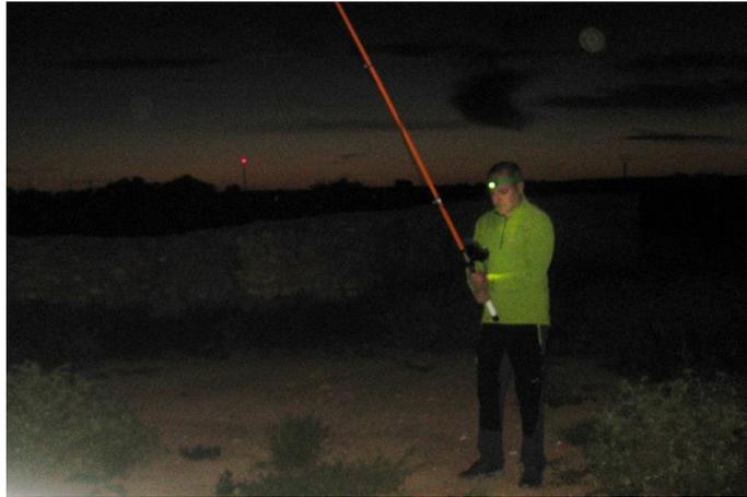
**Fotografía 2.6.3.6.b.** Acople del detector de ultrasonidos a pértiga para muestreos estacionarios. Fuente: Ideas Medioambientales, S.L.
