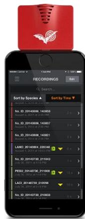
Figura 2.6.3.6.b. Echo Meter Touch 2 Pro acoplado a tableta digital y a teléfono móvil.
